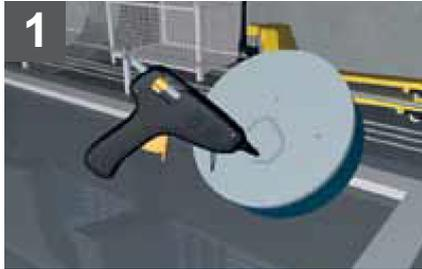
306mm Durchmesser - Unterteil/Deckel auf den Schaltisch kleben.
